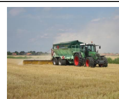
Unser Kalkstreuer mit Breitreifen und 12 m Arbeitsbreite in Aktion.
